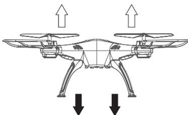
При перемещении левой ручки передатчика от себя модель набирает высоту, при перемещении этой ручки передатчика на себя – модель снижается.
