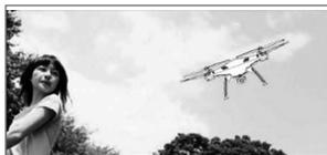
Данный квадрокоптер оснащен 6-и осевой системой стабилизации с встроенным гироскопом, и это значительно облегчает управление. После выполнения маневра вы можете просто отпустить ручку передатчика в центральное положение, слегка компенсируя ручкой газа потерю высоты, и квадрокоптер автоматически зависнет на месте в стабильном положении.
