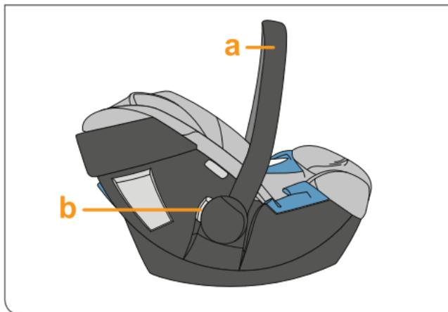
**!** **ПРЕДУПРЕЖДЕНИЕ!** Чтобы избежать нежелательного наклона креслицы, неся его, удостоверьтесь, что ручка зафиксирована в положении переноса **A**.
