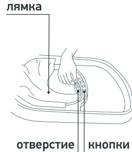
4. Чтобы собрать спинку, вставьте кнопки в отверстия в задней части панели. Затем зафиксируйте кнопки в отверстиях и вставьте кнопки на лямке в отверстия в передней части панели.
