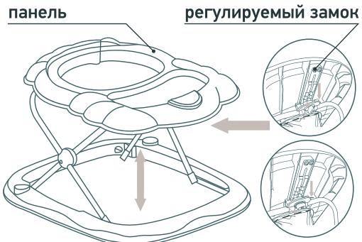
1. Отрегулируйте высоту ходунков: поднимите панель на нужную высоту (убедитесь, что она зафиксировалась).
