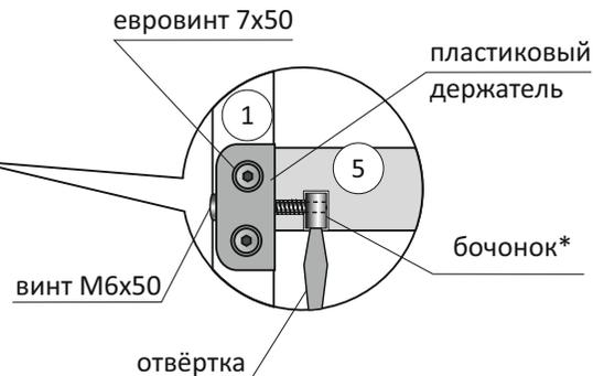
\* Бочонок устанавливается шлицей вниз. Чтобы бочонок и винт были соосны во время установки можно зафиксировать шлицу перпендикулярно спинке плоской отвёрткой.
