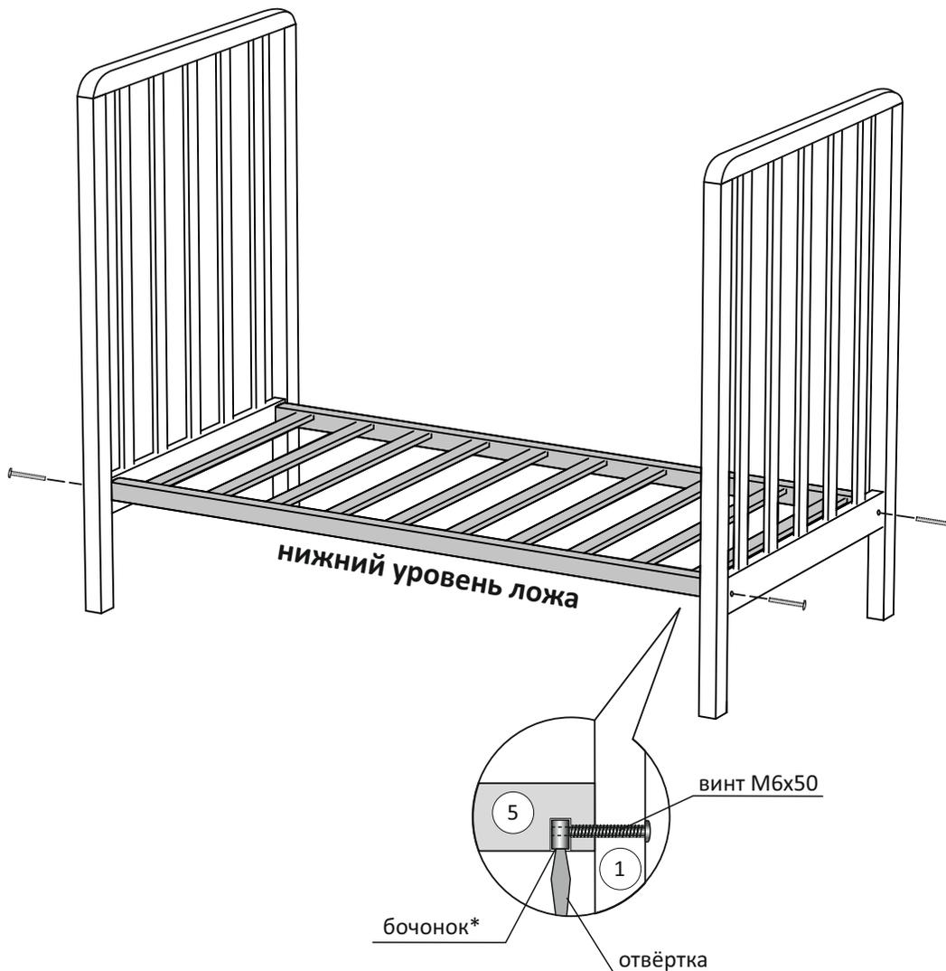
\* Бочонок устанавливается шлицей вниз. Чтобы бочонок и винт были соосны во время установки можно зафиксировать шлицу перпендикулярно спинке плоской отвёрткой.
