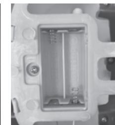
Для включения звуковых и световых эффектов вставьте батарейки в специальный отсек, находящийся под игровой панелью. Используйте 2 батарейки AA (не входят в комплект).
