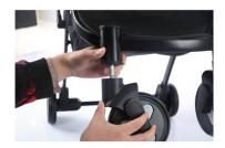
5. Передние колеса с функцией быстрого снятия, нажмите кнопку, снимите или установите колеса.
