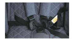
4. Замок ремня безопасности, может быть открыт автоматически при нажатии кнопки в центре.
