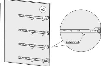
Порядок сборки соединений на эксцентриковые стяжки
