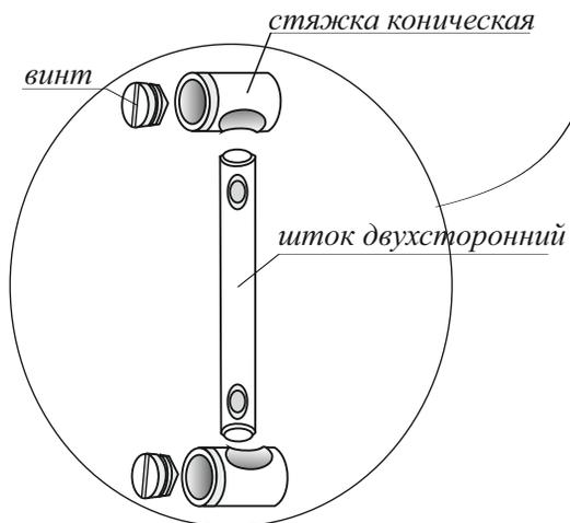
Рис.17 (Поз.№ 33 стяжка коническая двухсторонняя в сборе)
