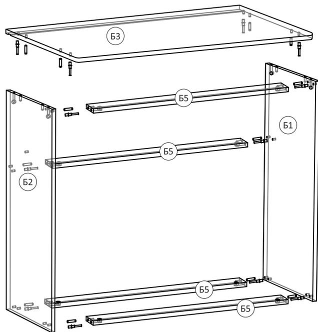
Порядок сборки соединений на эксцентровые стяжки
