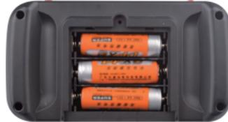
Снимите крышку отсека для батареек на пульте управления. Снимайте по направлению, указанному на крышке. При снятии используйте отвертку. Поместите в пульт управления 3 батарейки типа “АА” и закройте отсек для батареек.
