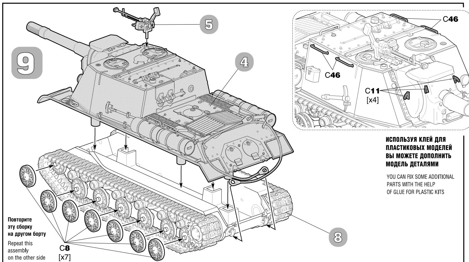
ИСПОЛЬЗУЯ КЛЕЙ ДЛЯ ПЛАСТИКОВЫХ МОДЕЛЕЙ ВЫ МОЖЕТЕ ДОПОЛНИТЬ МОДЕЛЬ ДЕТАЛЯМИ
