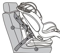
Протяните ремень безопасности автомобиля между базой и сидением автокресла. Закрепите ремень безопасности согласно рисунку C - D
