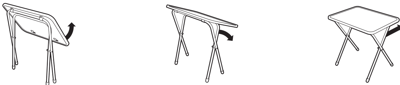
(рис. 4) Схема раскладывания стола (арт. КНД2)
