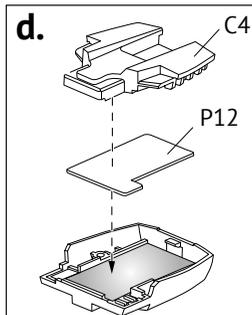
Установите магнитную пластину и крышку
