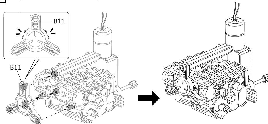
**09 Сборка корпуса энергетического модуля**
