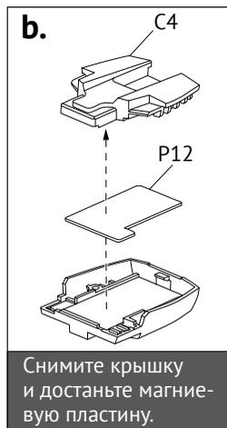
Снимите крышку и достаньте магнитную пластину.
