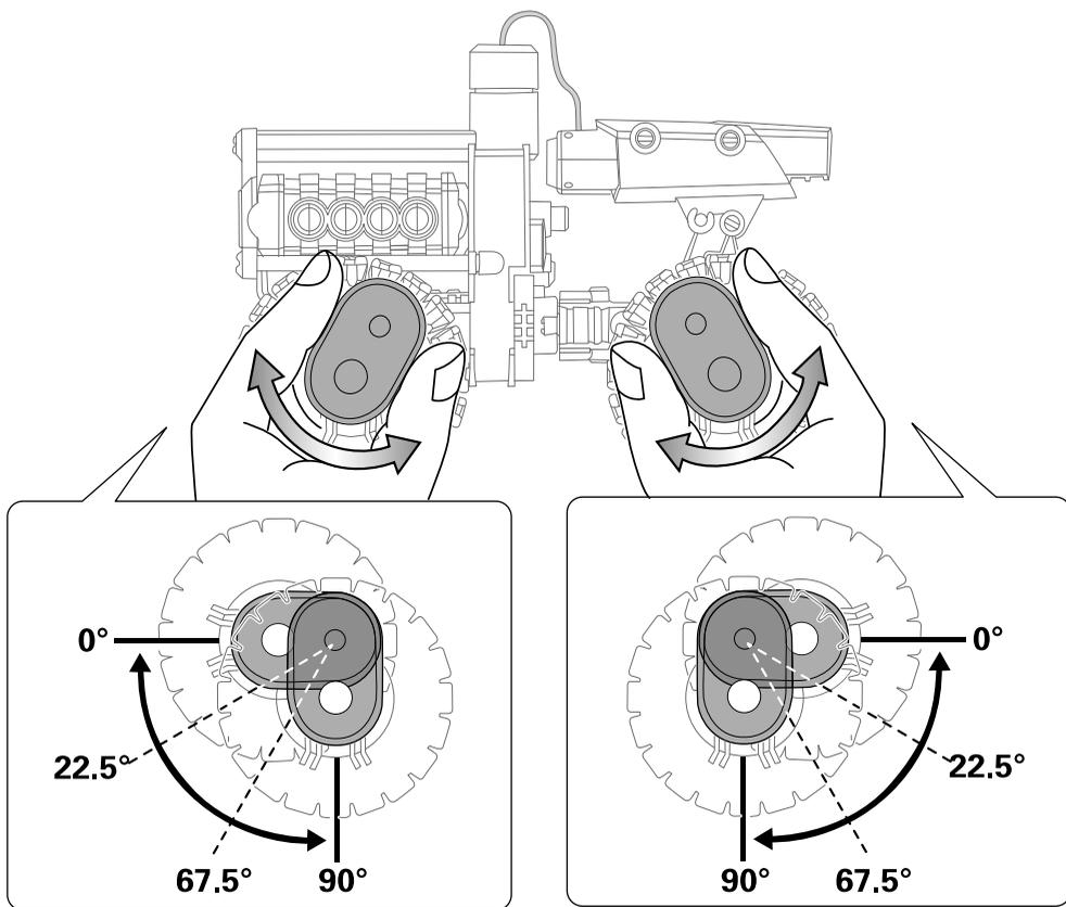
02 Выпуск или фиксация детали, как показано на рисунке, изменяют стиль движения монстр-трака от режима повышенной проходимости до стандартного режима.
