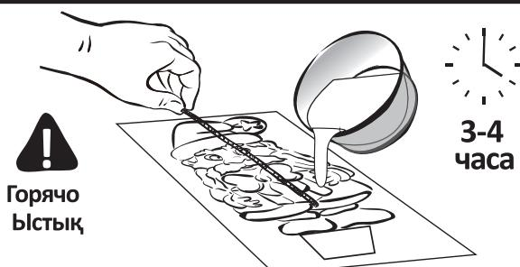
Вложите фитиль в пластиковую форму свечи. Место для фитиля обозначено выемкой вверху фигурки. Растопите парафин и залейте его в форму. Парафин не должен быть слишком горячим. После заливки подождите несколько часов, пока парафин застынет.
