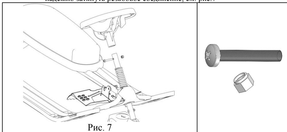
5.5. Проверить работу рулевой колонки. Угол поворота лыжи передней должен быть равен  $50^{\circ} \pm 5^{\circ}$  в обе стороны.
