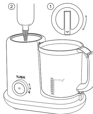
Откройте крышку резервуара для воды и налейте питьевую воду, в соответствии с таблицей по приготовлению продуктов. Шкала на внутренней стороне резервуара поможет быстро отмерить нужное количество воды. Закройте крышку по часовой стрелке.
