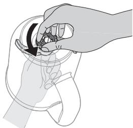
Разберите нож внутри кувшина. Для этого удерживайте гайку на внешней стороне кувшина и поверните ручку для ножа против часовой стрелки. Обратите внимание, что на ноже присутствует силиконовый уплотнитель. Всегда проверяйте наличие уплотнителя на ноже.
