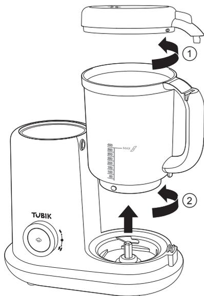
После разберите прибор. Снимите крышку кувшина, повернув за ручку крышки по часовой стрелке. Извлеките чашу для приготовления продуктов. Снимите кувшин, повернув ручку кувшина против часовой стрелки.
