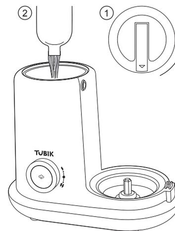
При первом использовании запустите цикл приготовления на пару без продуктов. Откройте крышку резервуара для воды, повернув крышку против часовой стрелки. Залейте воду до отметки максимум внутри емкости – 230 мл.
