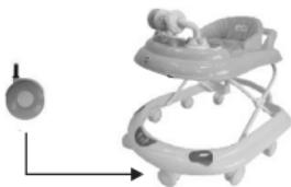
Вставьте колесики в соответствующие отверстия в основании ходунков. Применение специальных инструментов не требуется.
