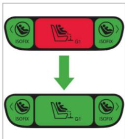
При правильно отрегулированной длине цвет индикатора опорной ножки изменится на зеленый, как только опорная ножка упрется в пол автомобиля. Если этого не произошло, выдвиньте опорную ножку еще немного.
