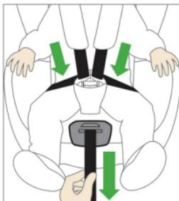
Натяните ремень, потянув за регулировочный ремень. Чем плотнее ремень натянут на ребенке, тем надежнее он зафиксирован в кресле Optifix. Поэтому в автомобиле рекомендуется снимать толстые крутки или свитера.
