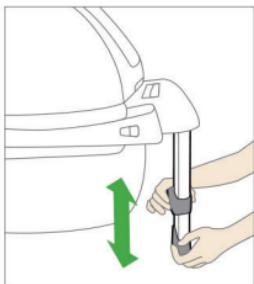
Для регулировки высоты опорной ножки нажмайте на фиксатор на передней стороне опорной ножки и выдвиньте опорную ножку на нужную длину. Проследите, чтобы опорная ножка зафиксировалась.
