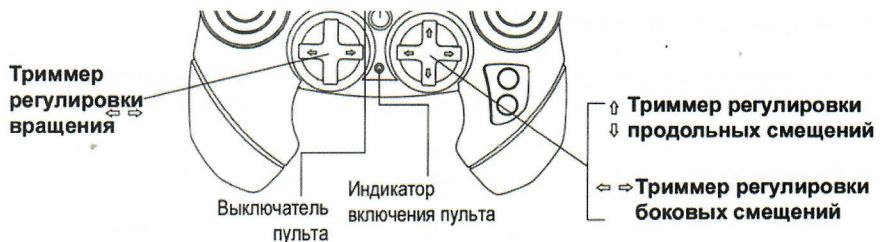
**РЕГУЛИРОВКА ВРАЩЕНИЯ** Если после взлета на 1,5 метра квадрокоптер непроизвольно вращается вокруг своей оси, такое вращение необходимо устранить при помощи **прерывистых** нажатий на триммер регулировки вращения (рис."вращение"):
