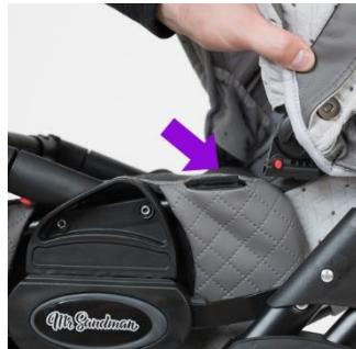
21. Надавите на стояночный тормоз ногой сверху, чтобы заблокировать колеса. Для разблокировки поднимите стояночный тормоз ногой вверх:
