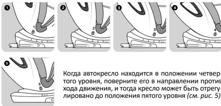
Когда автокресло находится в положении четвертого уровня, поверните его в направлении против хода движения, и тогда кресло может быть отрегулировано до положения пятого уровня (см. рис. 5).
