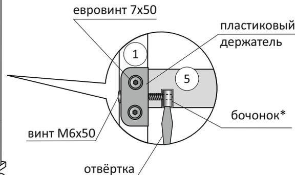
\* Бочонок устанавливается шлицей вниз. Чтобы бочонок и винт были соосны во время установки можно зафиксировать шлицу перпендикулярно спинке плоской отвёрткой.
