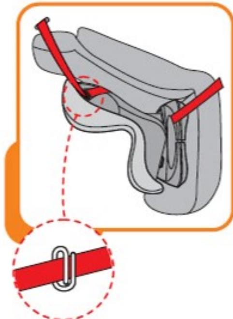
**Шаг 2. Закрепите диагональный ремень в двух отверстиях на спинке автокресла. Проденьте поясной ремень через два отверстия на основании автокресла.**
