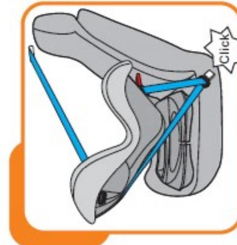
**Шаг 4:** Вставьте диагональный ремень вместе с поясным замком ремня в автомобильный замок ремня безопасности, услышав "щелчок". Проверьте, чтобы прядка ремня безопасности была правильно вставлена в замок.
