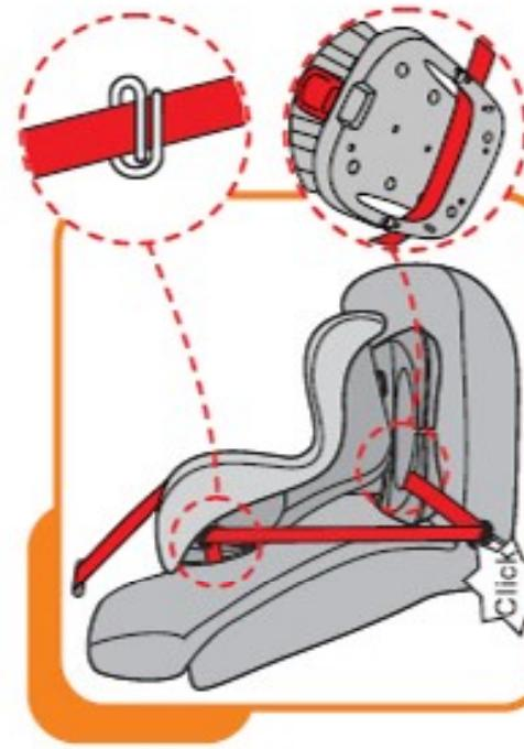
**Шаг 3. Вставьте диагональный ремень вместе с поясным ремнем в автомобильный замок ремня безопасности, услышав "щелчок". Проверьте, чтобы пружина ремня безопасности была правильно вставлена в замок.**
