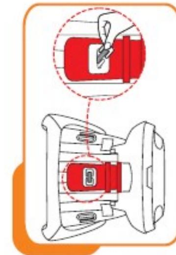
Установите детское сиденье в положение 3 и переверните его. Поверните замковую фиксирующую скобу узким концом и протяните через прорезь под нижней частью детского сиденья. Таким образом, чехол и пряжка, а также ремни безопасности могут быть сняты.
