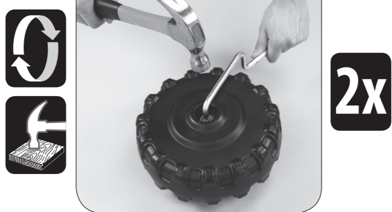
Hammer axle onto top hat. Repeat for RIGHT front axle. Martelez l'essieu sur l'écrou borgne. Répétez l'étape sur l'essieu avant DROIT. Martille el eje en el remate. Repita para el eje delantero DERECHO.
