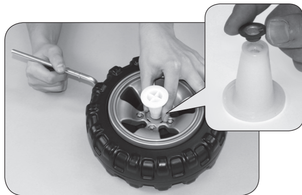
Place top hat tool with top hat onto open end of axle. Placez l'outil pour écrou borgne en mettant l'écrou borgne sur l'extrémité ouverte de l'essieu. Coloque el dispositivo para remate con el remate en el extremo libre del eje.
