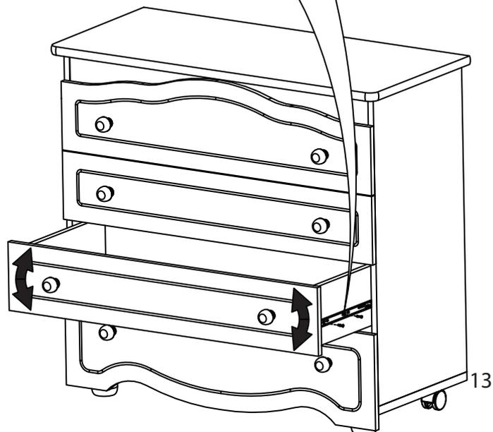
Если после установки ящиков зазоры между ними распределяются неравномерно - выдвиньте ящики, выкрутите 2 первых самореза (от лицевой стороны) из круглых отверстий и закрутите их в продолговатые пазы. Это позволит отрегулировать зазор между ящиками.
