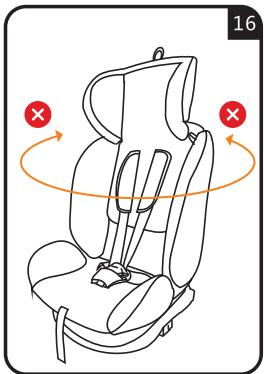
Во время вращения сидения кнопка будет подрагивать и щелкать. Установив автокресло в желаемом положении, отпустите кнопку и пошевелите сидение из стороны в сторону, чтобы убедиться в том, что оно прочно зафиксировано. (рис.16)
