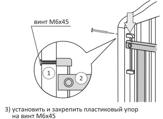
3) установить и закрепить пластиковый упор на винт М6х45
