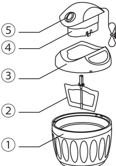
1. Вставьте моторный блок в крышку до щелчка.
