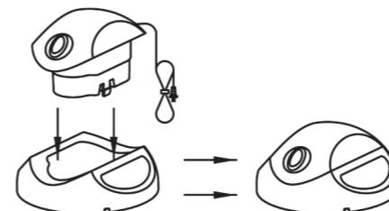
2. Чтобы достать моторный блок, одновременно нажмите на пластиковые защелки на крышке и вытяните моторный блок.
