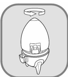
2. Покрутите, чтобы разблокировать и снять верхнюю часть.
