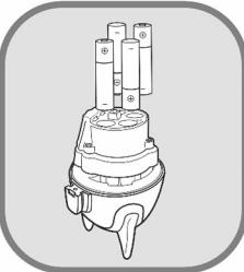
4. Снимите крышку отсека для батареек и вставьте 4 шт. типа АА.
