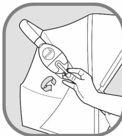
4. Поверните регулятор скорости, чтобы получить предпочтительное мягкое движение покачивания.
