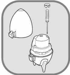
3. Открутите винт отсека для батареек.
