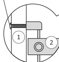
3) установить и закрепить пластиковый упор на винт M6x45
