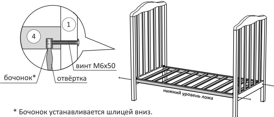
**36** Сборка механизма опускания (симметрично с 2х сторон)
