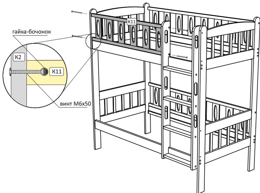
**4В** Установить нижнее переднее ограждение (K12) и закрепить к спинке, с помощью винтов M6x50 и гаек-бочонков, а стойку переднего ограждения (K14) стянуть к основанию с помощью винта M6x30 в верхнее отверстие, как показано на рисунке.
