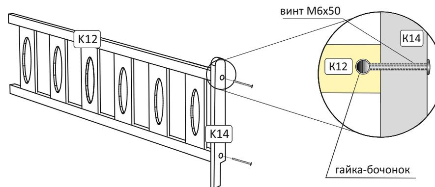
**4Б** Установить верхнее переднее ограждение (K11) и закрепить с двух сторон с помощью винтов M6x50 и гаек-бочонков, как показано на рисунке.
