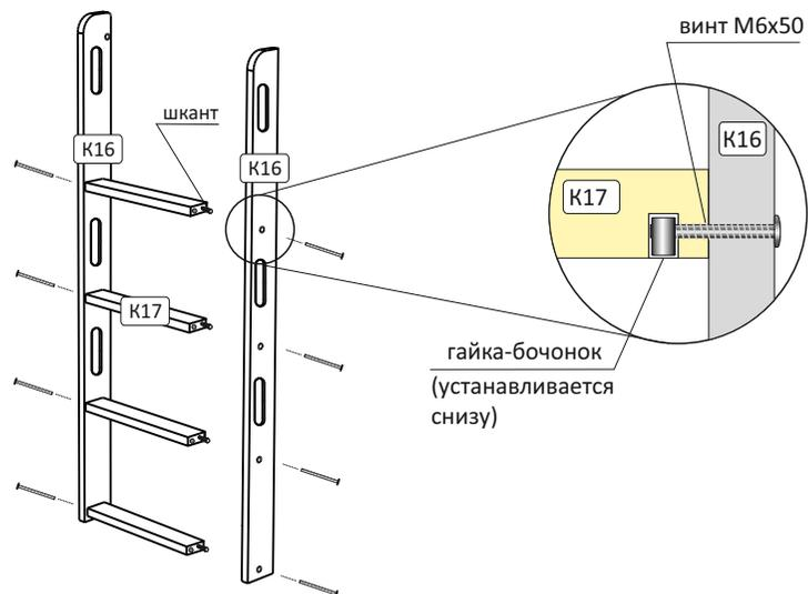
**3Б 1.)** Установить лестницу на каркас кровати и закрепить с помощью 4 винтов M6x50 и гаек-бочонков к основанию верхнего и нижнего яруса.
