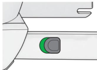
Удерживая кнопку TWINFIX (09) в вытянутом положении, подвиньте сиденье CONCORD TRANSFORMER, как можно плотнее, к спинке сиденья автомобиля. После того как детское сиденье установлено в требуемое положение, отпустите кнопку TWINFIX (09).
