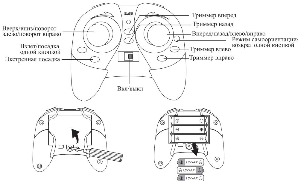
**Установка батареек:** Снимите крышку отсека для батареек на задней части пульта правления. Установите 3 батарейки типа "ААА" в отсек для батареек. Соблюдайте полярность. (Батарейки не входят в набор).
