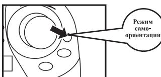
Шаг 1: Нажмите на кнопку режима самоориентации (показано на рисунке). Пульт управления издаст звук, а лампочки на квадрокоптере начнут мигать. Вы включили режим самоориентации. Для выключения режима самоориентации, нажмите на кнопку режима самоориентации еще раз. Пульт управления издаст звук, лампочки на квадрокоптере снова загорятся в обычном режиме.
