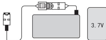
Время зарядки аккумулятора около 2 часов. Подключите аккумулятор к зарядному устройству. Подключите зарядное устройство в разъем USB компьютера. В процессе зарядки горит индикатор зарядного устройства. Индикатор перестает гореть, когда аккумулятор заряжен. Не оставляйте аккумулятор без присмотра в процессе зарядки.
