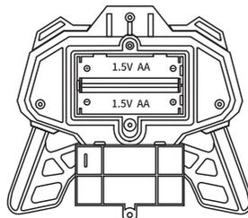
Выкрутите фиксирующий винт и откройте крышку.
