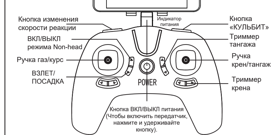
Схема показывает назначение ручек и кнопок передатчика.
