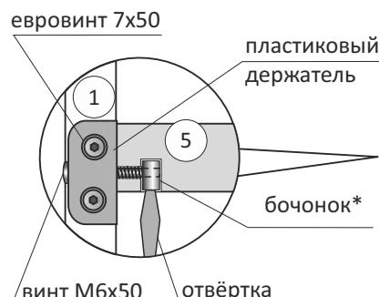
**36** Сборка механизма опускания
