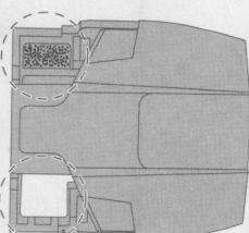
Вставьте топливную панель
