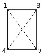
Начать забивать гвозди в последовательности, указанной на схеме.
