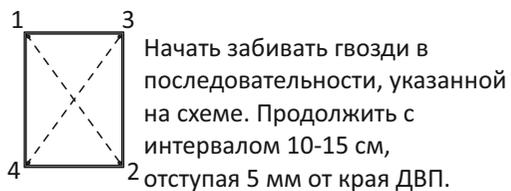
Начать забивать гвозди в последовательности, указанной на схеме. Продолжить с интервалом 10-15 см, отступая 5 мм от края ДВП.
